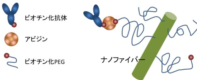
ナノファイバー表面のアミノ基にポリエチレングリコールをグラフトし、その末端に抗体を固定した。
