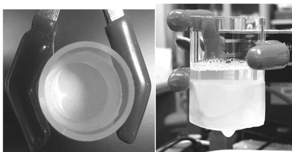
Fig. 1 NF不織布の漏水性評価試験
