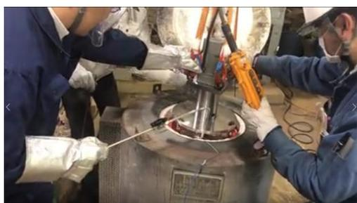
図1 攪拌鋳造実験の様子
