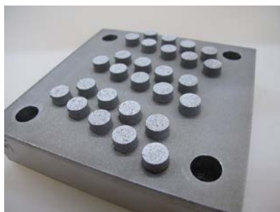
タングステン材料粉末を用いた3D造形の事例
