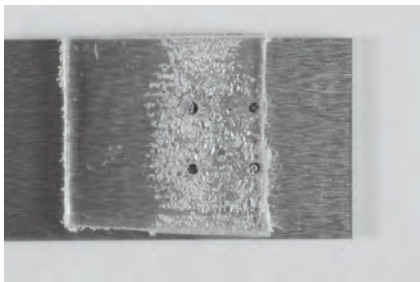
図3 4点貫通におけるPET破断例
