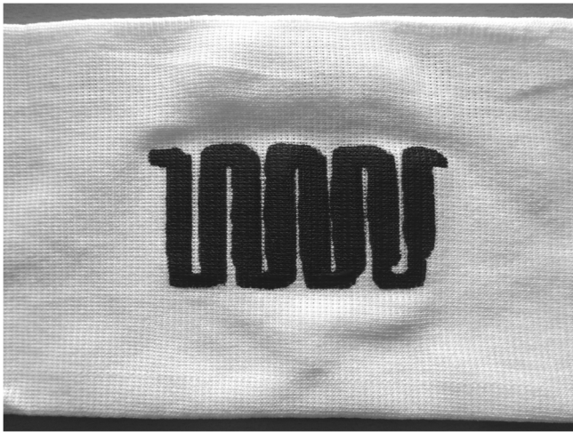
図3 サポータ上へ印刷した導電性樹脂
