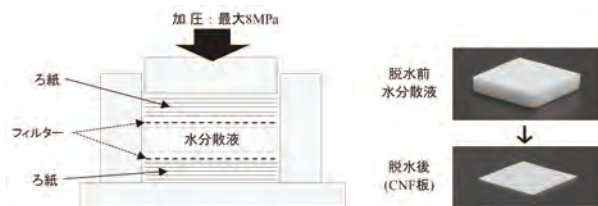
図1 CNF板作成方法模式図
