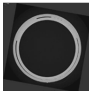
図1 ロウ付け部断面（CT像）
