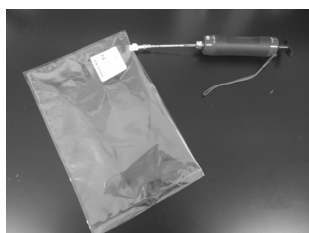
図1 ガス検知管による消臭効果試験
