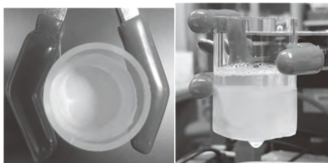
Fig. 1 NF不織布の漏水性評価試験
