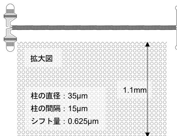
Fig. 1 流路（閾値約 2.0\mu\text{m} ）の全体図と拡大図
