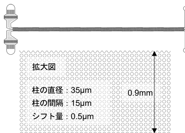
Fig. 2 流路（閾値約 1.8\mu\text{m} ）の全体図と拡大図
