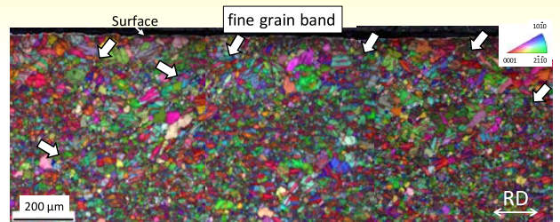
図2 AZ31Bコイル圧延材(受入材)のEBSD IPFマップ
