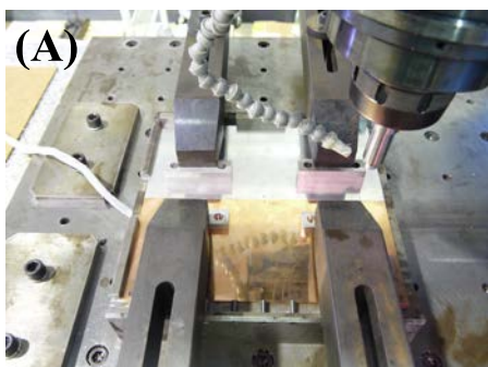
A: 接合試験の状況, B: 接合されたアルミニウムと銅
