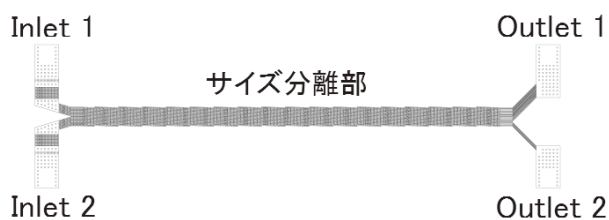
図 1 チップの構造
