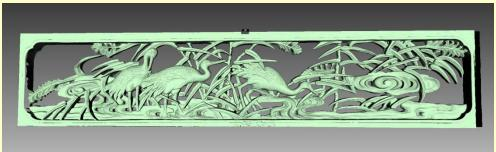
●現行の鋳造品のサイズダウンを図るため、3Dプリントによる原型製作用の形状データを取得。
