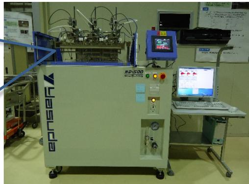
熱変形温度測定装置
