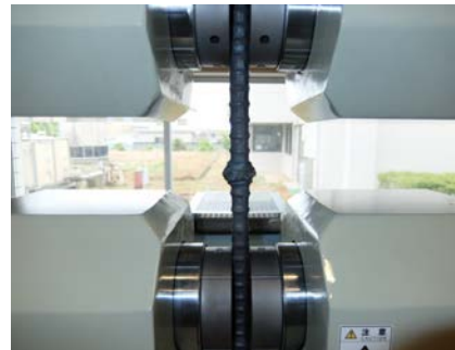
ガス圧接継手の引張試験
