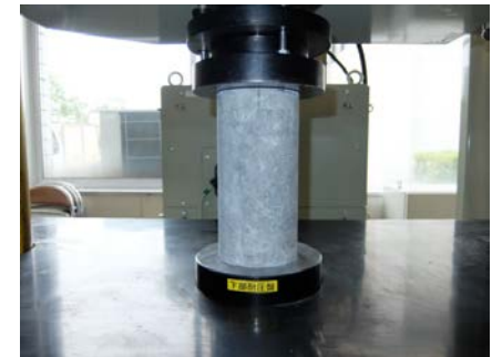
コンクリートの圧縮強度試験
