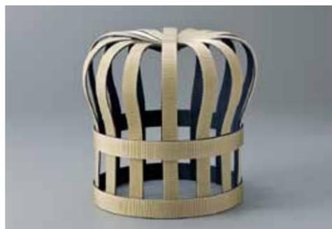
乾漆の製法を応用したバスケット。一般的にはベルトとして使用されているPPベルトを樹脂で積層して素材を形成。樹脂を接着材の代わりとし、PPの繊維の間に入り込ませ強度を持たせています。乾漆の麻材の特徴である繊維に漆がしみこまないと生まれる強度を今回PPシートに応用しました。また、表面には樹脂材は塗っておらず積層する内側のみに樹脂を塗ることで普段親しみなれているPPの質感をそのままに新たなプロダクトへの発展ができるのではないかと考えました。
