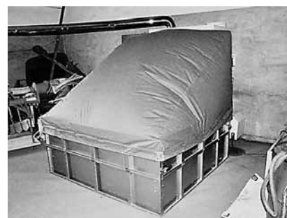
図2 改良された平型乾燥機（幌状シート使用時）
