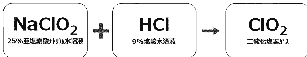
図1. 二酸化塩素生成の反応式
