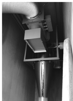
図2 コイン精米機に組み込んだ試作消音器
