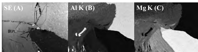
図6 割れ発生部近傍のSEM像および特性X線像
