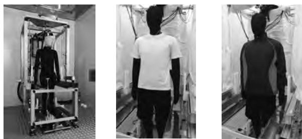
図1 発汗サーマルマネキンとウェアの装着状態
