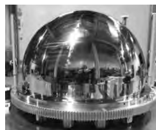
図5 試作ドーム型真空容器の外観(直径 600mm)
