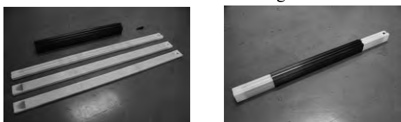
Fig. 1 中子内部にウレタンゴムを注入した中子
