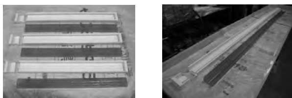
Fig. 2 ウレタンゴムで成形した中子、スペーサー
