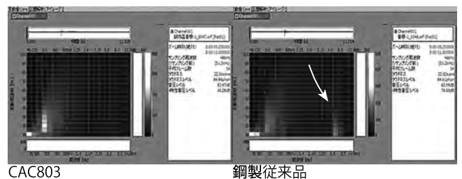
Fig. 3 試験片の変動音周期特性測定結果の例
