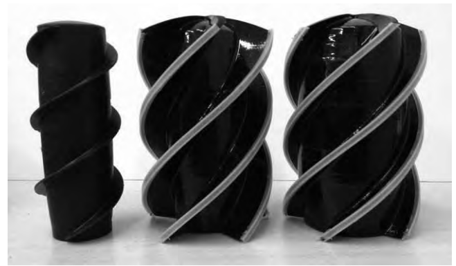
初期型 試作 I 型 試作 II 型 図 4 試作した車輪形状
