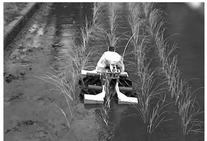
図 5 試作車輪での走行試験
