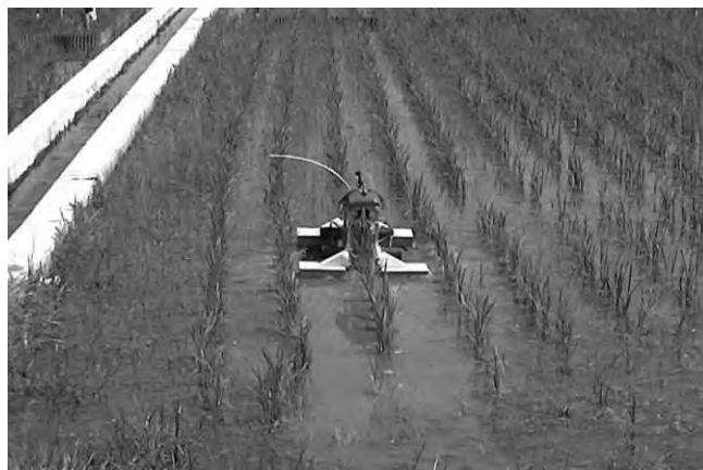
図2 圃場での走行(除草)試験
