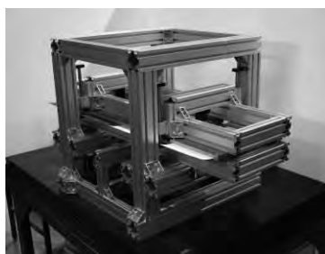
図2 屈曲疲労試験機
