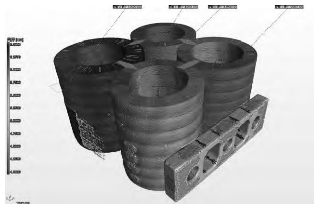
Fig. 1 大型X線CTによる肉厚分布の測定例
