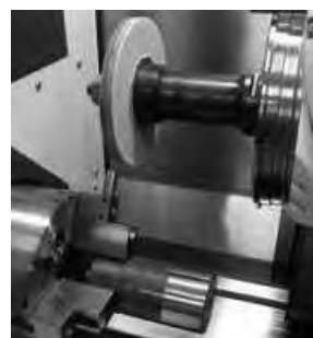
Fig.3 複合作業機械での研削加工状況
