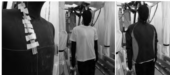
図2 温湿度センサの取付けと着装状態
