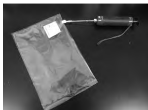
図 1 ガス検知管による消臭効果試験
