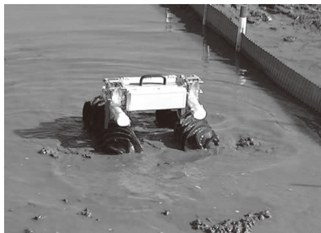
図 2 改良車輪駆動試験
