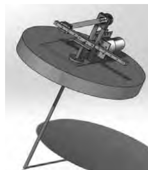
図1 3次元CADによる水面浮遊型ガス抜き・抑草ユニット試作機的设计
