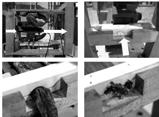
Fig. 6 樹脂ブロックとベルトサンダーの組み合わせ及び楮の表皮の剥ぎ取り実験
