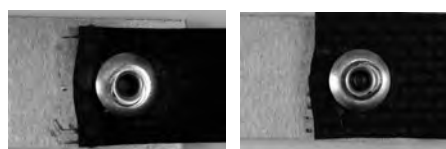
Al+CFRP (レーザ 1000W) Al+CFRP (WJ)
