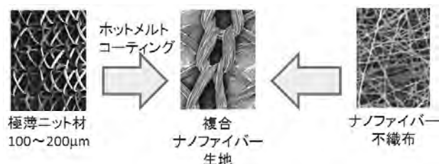
Fig. 2 ハイブリッド極薄基布の製法ならびに SEM 観察図
