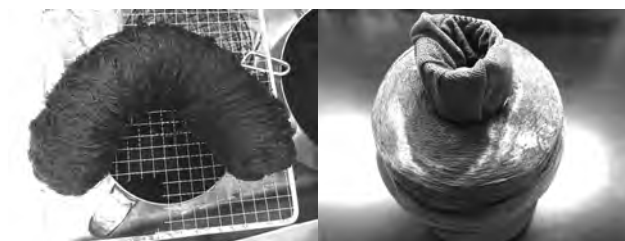
Fig. 3 染色されたゆるいカセ巻 PP とチーズボビン巻 PP
