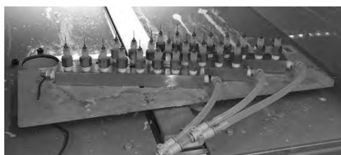
図1. 連続ナノファイバー量産装置におけるノズル増設試験の様子
