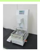
口腔内崩壊錠の崩壊性を評価する試験器。
