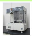
カサ密度(ゆるめ・ 固め)や安息角、凝集 度など、粉体物性の多 くの項目を測定できる 装置。
