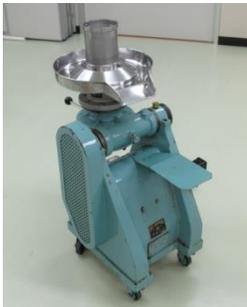
原料粉末に結合剤を加えて練合し、練合物をスクリーンから強制的に押し出して成型造粒する装置。顆粒剤の製造ができるほか、球形造粒機と組み合わせることで球形顆粒の製造も可能。
