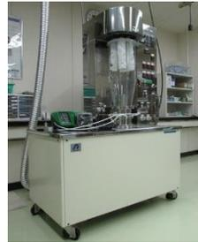
原料粉体を下方からの熱気流によって流動させつつ、造粒容器、攪拌羽根等を交換することで、様々な用途に応じた粒子加工が可能な装置。10 $\mu$ m以下の粒子への微粒子コーティングが可能。
