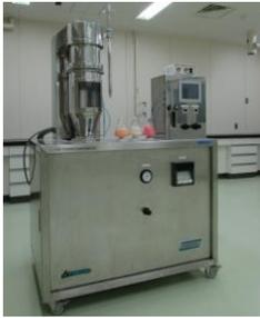
粉体を下方から熱気流により流動させ、これに結合剤溶液をスプレーして造粒する装置。軽質で多孔性の造粒物が得られることから打錠用顆粒の製造に適している。
