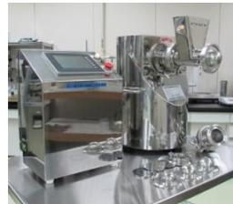
原料粉末に結合剤を加えて練合し、練合物をスクリーンから強制的に押し出して成型造粒する装置。前押し（ドーム型・平面）と横押しとの両方式での押し出しが可能。
