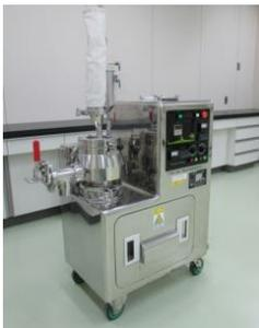
容器底面の攪拌羽根と側面の解砕羽根を高速で回転させることによって造粒する装置。重質で球形の造粒物が得られることから、顆粒剤の製造に適している。
