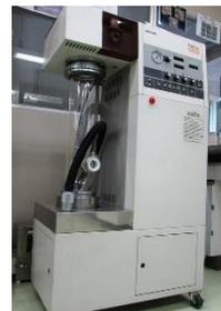
原液を高温の乾燥室内に噴霧することにより、急速に乾燥させ、乾燥粉体を製造する装置（スプレードライ方式）。乾燥粉体はサイクロンにより回収される。
