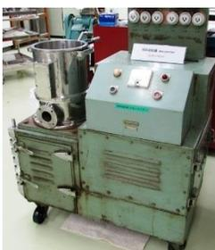
押し出造粒によって得られた湿潤状態の円柱状顆粒を凹凸のあるマルメプレートの回転によって球形化する装置。円柱状顆粒の長さを揃える整粒機としても使用可能。
