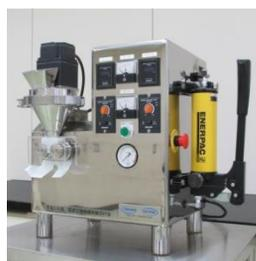
2つのロールによって圧縮成形された原料粉末（フレーク）を、専用の整粒機で破碎・整粒して顆粒に加工する装置。
