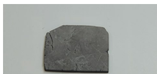
正極基板に固体電解質を塗布
