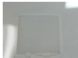
ガラス基板上に印刷焼成した固体電解質膜
