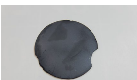
正極基板(コバルト酸リチウム)
