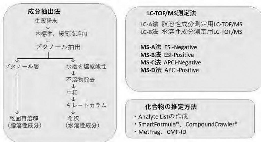
図1 LC-TOF/MSによる成分分析手法
