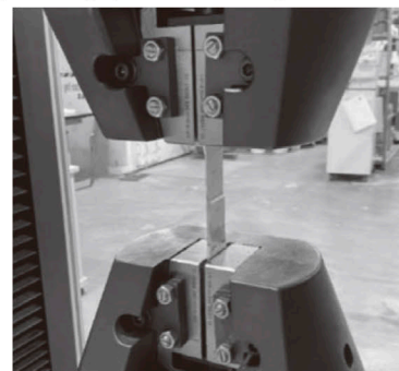
図1 溶接試験片の引張試験
