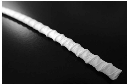
Fig. 1 作製した縫合糸補強人工血管
