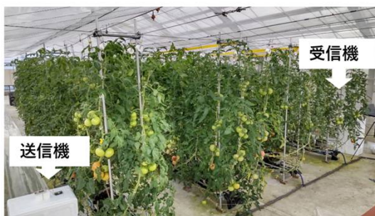
実験施設園芸内の電波通信強度分布の測定風景及び測定結果
