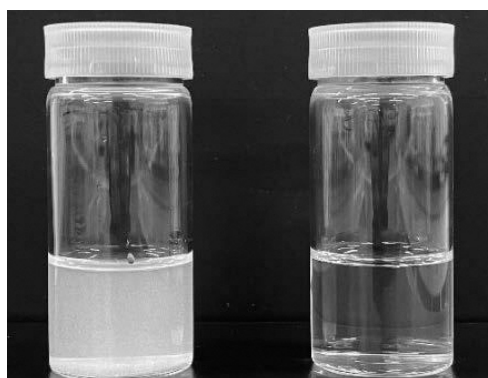
図4. ケトチフェンカプセルのマイクロ波分解 フッ化水素酸なし（左）、フッ化水素酸あり（右）
