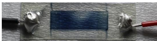
実際に作製した温度センサ
